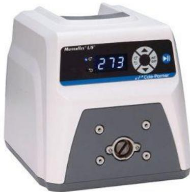
Прецизионный консольный привод с переменной скоростью Masterflex L/S прост в эксплуатации и оснащен светодиодным дисплеем, на котором отображается скорость. Привод насоса имеет регулируемое направление вращения и может управляться извне с помощью 4–20 мА, 0–10 В постоянного тока или запускаться/останавливаться с помощью бесконтактного замыкающего/размыкающего контакта или сигнала TTL 5 В.
