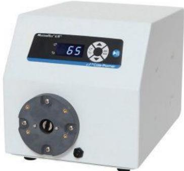
Прецизионный консольный привод с переменной скоростью L/S водонепроницаем, прост в эксплуатации и оснащен светодиодным дисплеем, на котором отображается число оборотов в минуту. Привод насоса имеет регулируемое направление вращения и может управляться извне с помощью 4–20 мА, 0–10 В постоянного тока или запускаться/останавливаться с помощью бесконтактного замыкающего/размыкающего контакта или сигнала TTL 5 В. Доступен с корпусом из нержавеющей стали или стали с порошковым покрытием.
