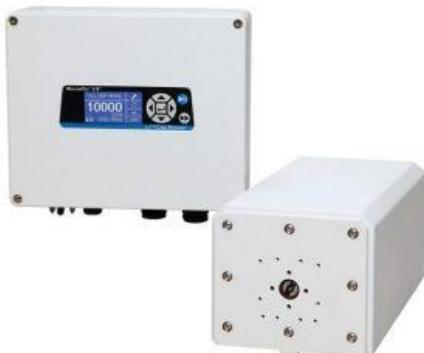
Модульный цифровой привод промывки Masterflex L/S с настенным контроллером обеспечивает калиброванную перекачку и дозирование. На дисплее отображается громкость [например. мл], скорость потока [например мл/мин] или количество оборотов в минуту. Для каждого размера шланга калибровку можно сохранить в памяти привода. Эта калибровка сохраняется в памяти даже при выключении привода.
