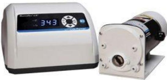
Прецизионный модульный привод Masterflex L/S с настольным контроллером прост в эксплуатации и оснащен светодиодным дисплеем, отображающим скорость. Привод насоса имеет регулируемое направление вращения и может управляться извне с помощью 4–20 мА, 0–10 В постоянного тока или запускаться/останавливаться с помощью бесконтактного замыкающего/размыкающего контакта или сигнала TTL 5 В.
