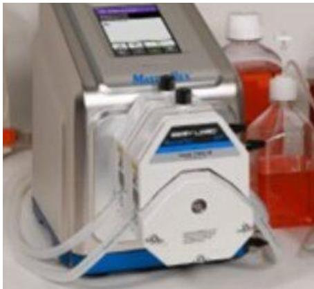
Универсальный привод насоса для точной подачи жидкости. Быстрое и простое программирование с помощью сенсорного экрана. Можно сохранить и вызвать до 50 программ. 0,0006–19 л/мин.
