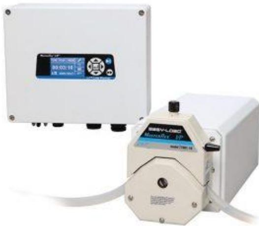
Модульный привод Masterflex I/P с переменной скоростью промывки обеспечивает калиброванную перекачку и дозирование. На дисплее отображается объем [мл], скорость потока [мл/мин] или количество оборотов в минуту. Для каждого размера шланга калибровку можно сохранить в памяти привода. Эта калибровка сохраняется в памяти даже при выключении привода. Контроллер и блок двигателя имеют высокую степень защиты от воды и пыли (IP66).
