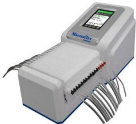
Эта серия шланговых насосов Ismatec оснащена планетарным приводом, обеспечивающим очень низкую пульсацию и более длительный срок службы трубок. Используйте до 24 каналов со скоростью потока до 44 мл/мин. Благодаря высокой точности и разнообразным функциям, таким как непрерывная перекачка и дозирование, эта серия шланговых насосов подходит для многих применений с низким расходом.
