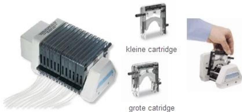
Головки картриджных насосов делятся на области применения с высокой или (очень) низкой производительностью. Головки насоса оснащены 3, 4, 6 или 8 роликами. Количество роликов определяет импульсный эффект и точность. (больше роликов, меньше импульсный эффект, выше точность.)
