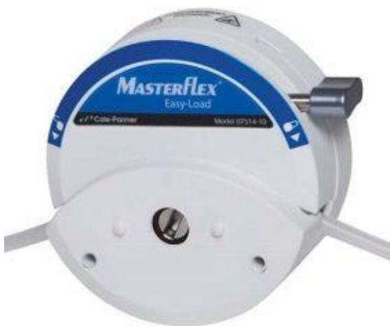
Новая головка насоса Masterflex Easy-Load более компактна и оснащена 4 роликами для снижения пульсации. Улучшенная окклюзионная подушка снижает износ шланга и продлевает срок службы шланга насоса. Шланг насоса очень легко и быстро меняется. Головка насоса совместима со шлангами различных размеров. Головка насоса прочная и оснащена ротором из нержавеющей стали, устойчивым к коррозии, с подшипниками, защищенными ПТФЭ.
