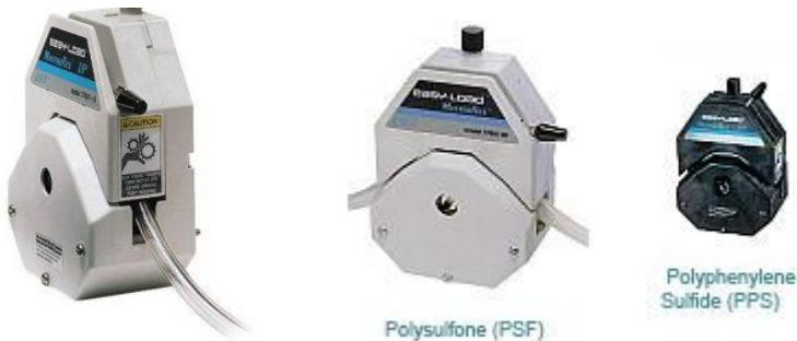
Головка насоса Masterflex I/P Easy-Load позволяет быстро и легко менять шланги насоса. Шланг насоса автоматически фиксируется при закрытии головки насоса. Ротор из стали или нержавеющей стали имеет три ролика, установленных на подшипниках. Головка насоса совместима с трубками Masterflex I/P следующих размеров: I/P-26, I/P-73 и I/P-82. Производительность насоса: 0,01–13 л/мин.
