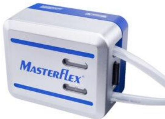
Головка насоса Masterflex I/P Rapid-Load — это прочная головка насоса для тяжелых условий работы. Доступен в версии для тонкостенных шлангов Masterflex I/P, а также для толстостенных шлангов Masterflex I/P. Головка насоса оснащена ротором из нержавеющей стали с 3 роликами из нержавеющей стали. Производительность насоса от 0,67 до 19 л/мин
