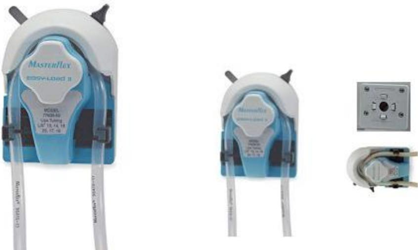
Головка насоса Masterflex Easy-Load 3 — новейшая головка насоса в серии Easy-Load. Корпус изготовлен из высокопрочного полипропилена (ПП). При закрытии головки насоса материал шланга автоматически фиксируется и натягивается. Ротор из стали или нержавеющей стали имеет три ролика, установленных на подшипниках. Производительность насоса: 0,001–2900 мл/мин.
