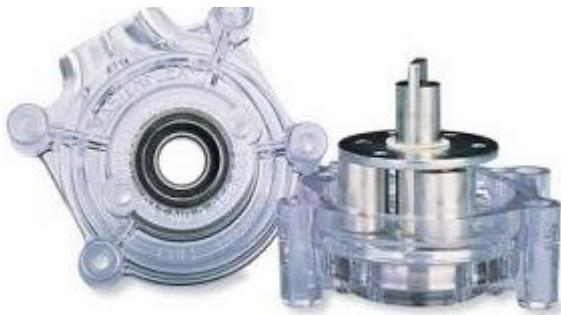
Головка насоса Masterflex L/S Standard — это простая, конкурентоспособная по цене головка насоса с компактными размерами и высокой точностью. Головка насоса подходит для шланга одного размера. Ротор содержит три ролика, установленных на подшипниках. В зависимости от используемого привода на одном приводе можно установить до четырех стандартных головок насоса.
