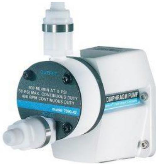
Преобразуйте перистальтический насос Masterflex в мембранный насос за считанные минуты с помощью головки мембранного насоса L/S. Головка насоса имеет малый мертвый объем, а жидкость контактирует только с химически инертным материалом ПТФЭ. Производительность насоса: 10–800 мл/мин.
